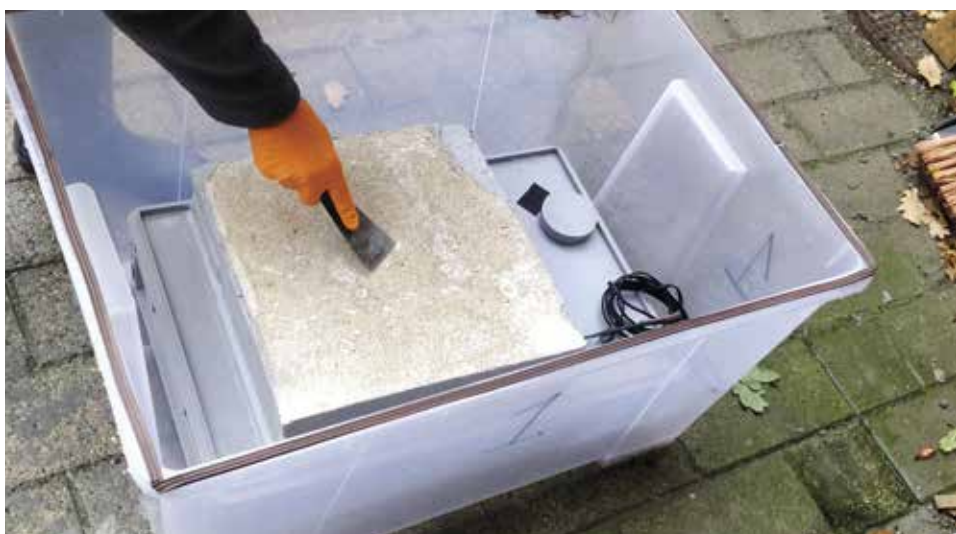
Afrensningstest 1: Her fjernes tapetrestere og synlige klisterrester fra en testvæg ved håndkraft med spatel. Undersøgelsen viste, at denne metode kan efterlade massive mængder skimmelsporer.
