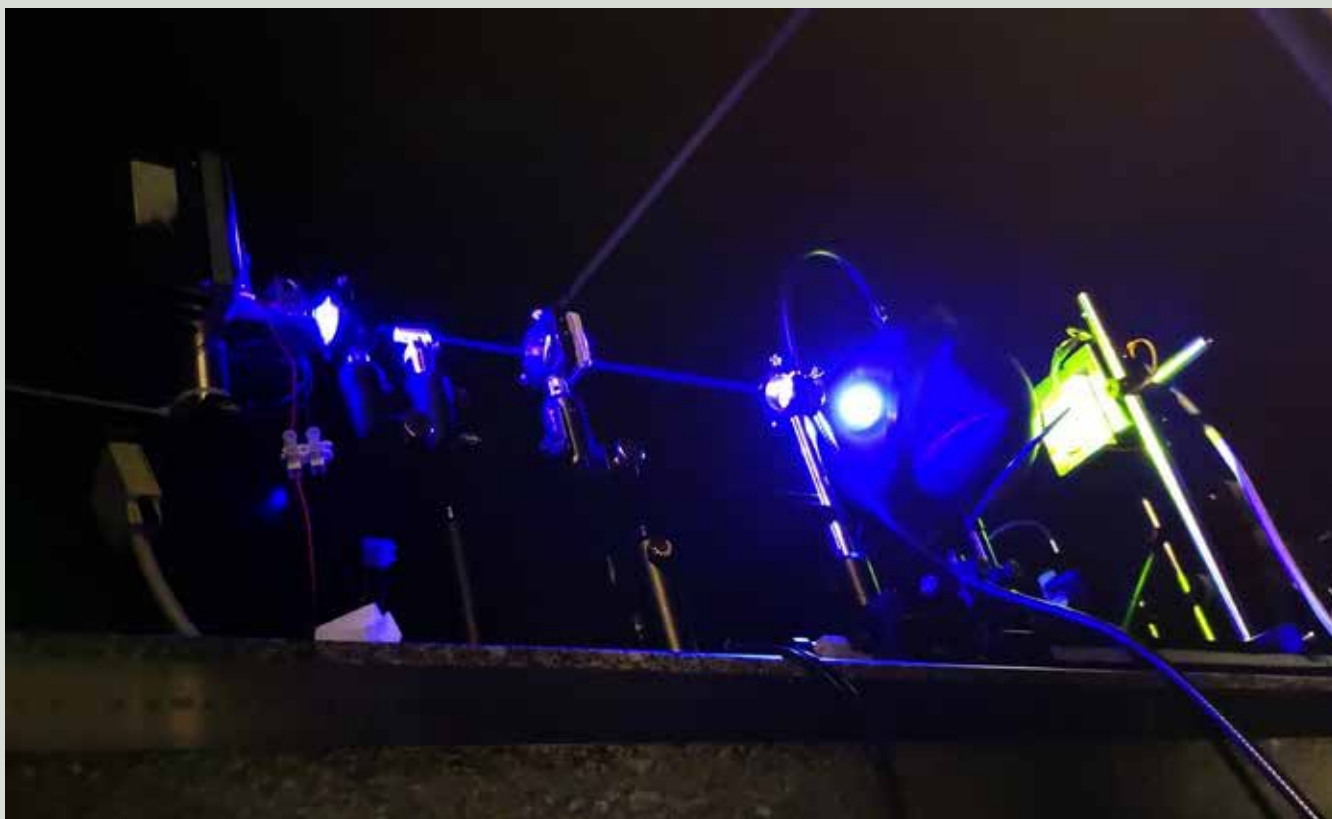
Eksperimenter med laserbaseret belysning på DTU Fotonik. Den blå laserstråle ledes gennem nogle linser og rammer et fosformateriale, hvor det hvidgule lys dannes.
